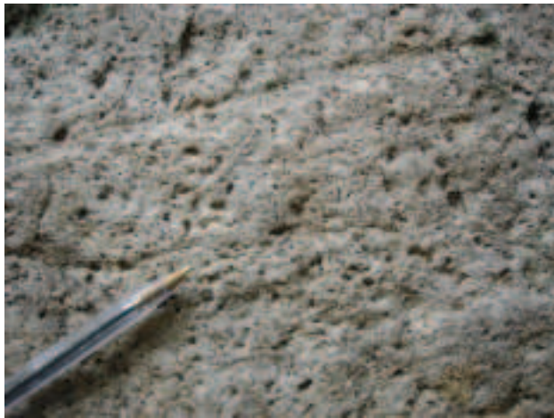
Photo 3 : Aspect macroscopique vacuolaire de la surface du rocher après élimination manuelle des recouvrements biologiques
