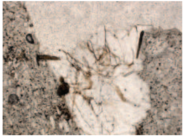
Photo 4 : Observation au microscope polarisant sur lame mince pétrographique en lumière naturelle polarisée. Corrosion d'un feldspath alcalin au voisinage de la surface. Petit coté de la photo = 1mm
